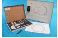
Para el estudio de los principios básicos de la óptica geométrica incluida la reflexión total en la fibra óptica. Incluye 6 láminas magnéticas con dibujos realizados para situar las lentes y ayudar a demostrar: modelo de ojo humano y uso de lentes correctoras, funcionamiento de la cámara fotográfica, dos tipos de telescopios (Galileo y Kepler), aberración esférica y disco graduado para estudio de reflexión y refracción.
